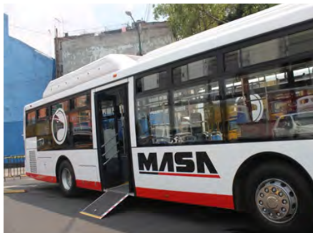
Imagen 16 Rampa para acceso con silla de ruedas.
